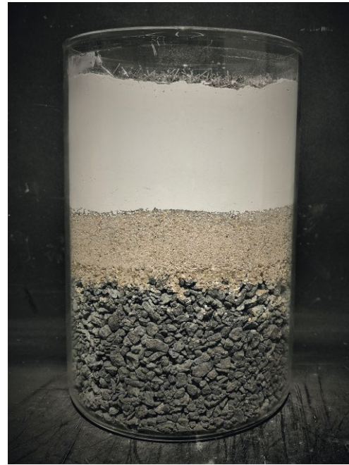
Bild 5 Ausgangsstoffe für CONTEC Ferroplan, unten Hyperit (2/5 mm), mittig Feinsande (0,1/1,4 mm), oben Binder N und Stahlfasern Source materials for CONTEC Ferroplan, bottom Hyperit (2/5 mm), centre fine sands (0.1/1.4 mm), top Binder N and steel fibres
